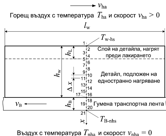
Фиг. 2. Позициониране на възлите на 1D изчислителна мрежа върху дебелината на подложени на едностранно конвективно нагряване плоски дървени материали
