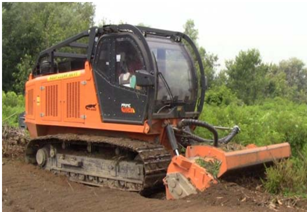
Фиг. 1. Специализиран фрезов агрегат РТ-400 с горска фреза FAE 300/S по време на почвоподготовка в тополово сечище в района на Козлодуй (сн. К. Маринов)
