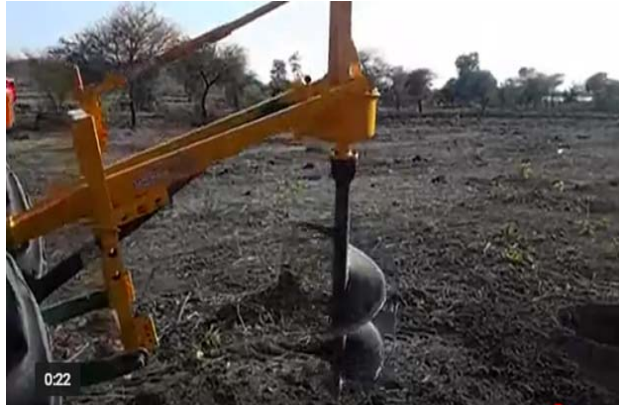
Фиг. 2. Отваряне на дупки с тракторен свредел за садене на топови фиданки (сн. Ив. Иванов)
