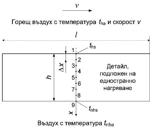
Фиг. 1. Позициониране на възлите на 1D изчислителна мрежа върху дебелината на подложени на едностранно конвективно нагряване плоски дървени материали
