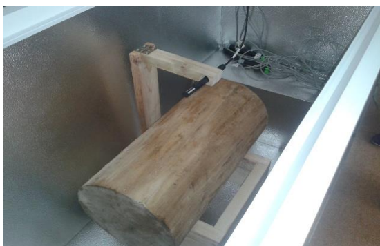
Фиг. 2. Измерване на T_m във фризер по време на замразяване в него на объл буков материал
