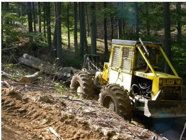
Фиг. 1. Общ изглед на специализирания колесен трактор с шарнирна рама за дърводобива LKT-81T
