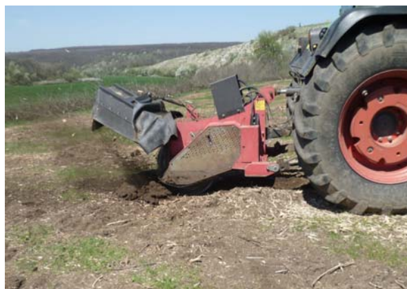
Фиг. 4. Фрезоз агрегат за раздробяване на пънове и дълбоко фрезозане АНВИ SF100
