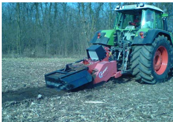
Фиг. 4. Фрезоз агрегат за раздробяване на пънове и дълбоко фрезозане АНВИ SF100
