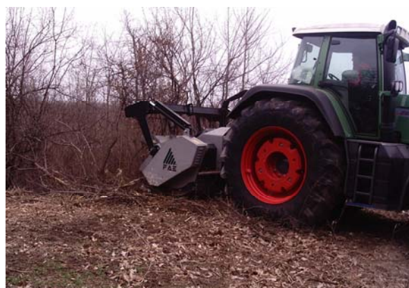
Фиг. 2. Фрезен агрегат за мулчиране FAE UMH/S 200 с трактор FENDT 926
