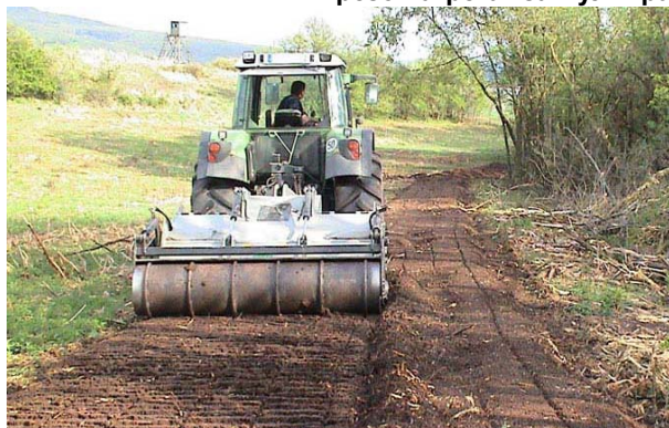
Фиг. 3. Фрезен агрегат за почвоподготовка FAE SSH с трактор FENDT 926
