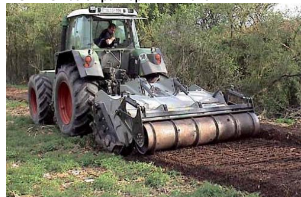
Фиг. 3. Фрезен агрегат за почвоподготовка FAE SSH с трактор FENDT 926
