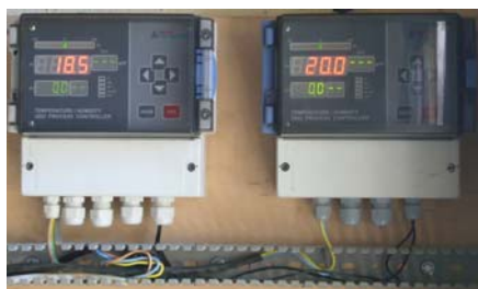
Фиг. 6. Програмируеми контролери (ляво) за автоматично управление на процеса на термично обработване на съдържащи и несъдържащи лед трупци в пропарващи ями (дясно)
