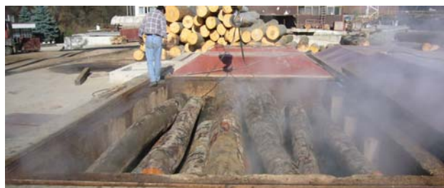
Фиг. 6. Програмируеми контролери (ляво) за автоматично управление на процеса на термично обработване на съдържащи и несъдържащи лед трупци в пропарващи ями (дясно)
